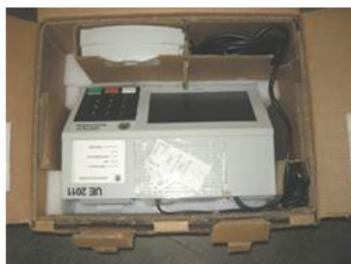
Foto 9 - Posicionamento dos acessórios e acondicionamento da urna
