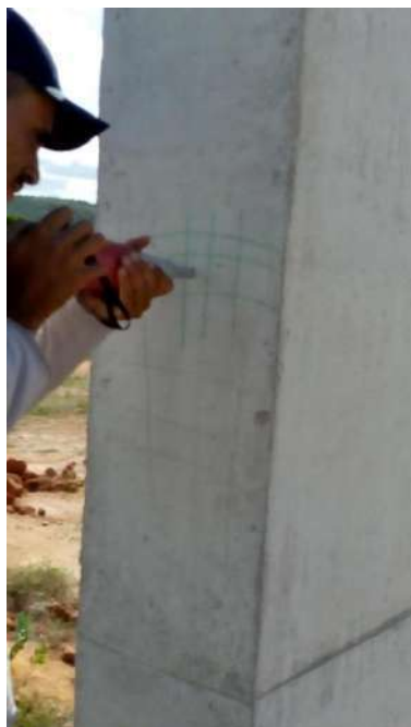
Fotografias n.º 305, 306, 307, 308, 309 e 310 – ensaio de esclerometria do Bloco Pedagógico P28, P29, P30, P31 e P32 (pavimento superior) respectivamente.
