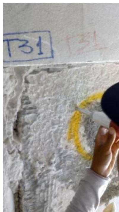
Fotografias n.º 101, 102, 103, 104, 105 E 106 – ensaio de esclerometria da Auditório V5 (pavimento fundação); P1, P2, P3, P4 e P5 (pavimento térreo) respectivamente.
