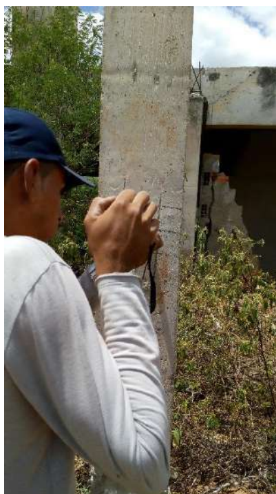
Fotografias n.º 190, 191 e 192 – ensaio de esclerometria da Passarela P10, P11 e P12 (pavimento térreo) respectivamente.
