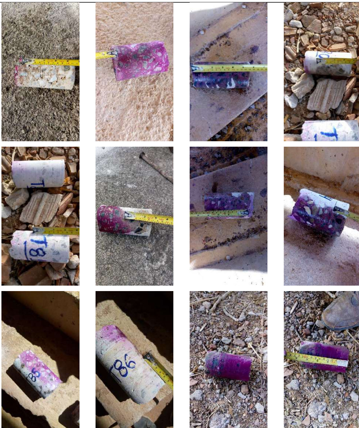
Fotografias n.º 670 a 681 – ensaio de profundidade de carbonatação, T77 a T88, respectivamente.
