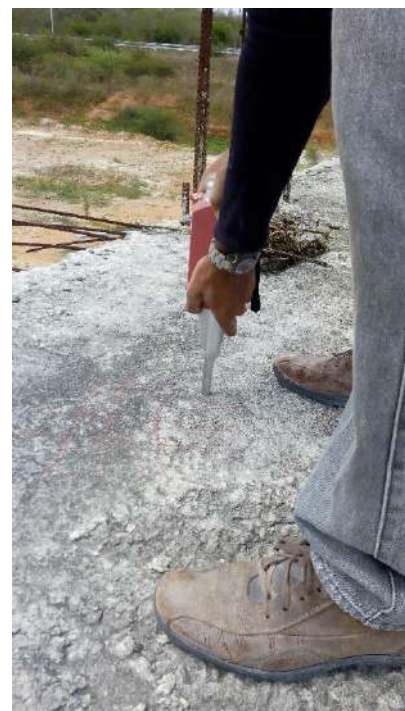
Fotografias n.º 83, 84, 85, 86, 87 e 88 – ensaio de esclerometria da Biblioteca, P7, P8, PC1, PC2, PC3 e L2 (pavimento superior) respectivamente.
