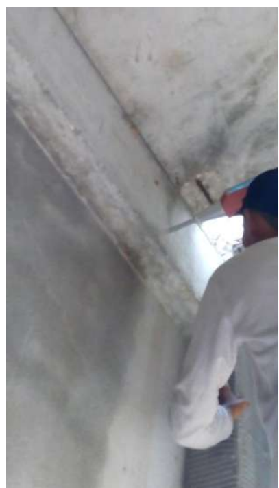
Fotografias n.º 113, 114, 115, 116, 117 e 118 – ensaio de esclerometria da Auditório V3, V4, V5, V6, V7 e V8 (pavimento térreo) respectivamente.
