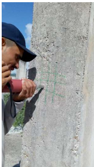
Fotografias n.º 299, 300, 301, 302, 303 e 304 – ensaio de esclerometria do Bloco Pedagógico P21, P22, P23, P24, P25 e P27 (pavimento superior) respectivamente.
