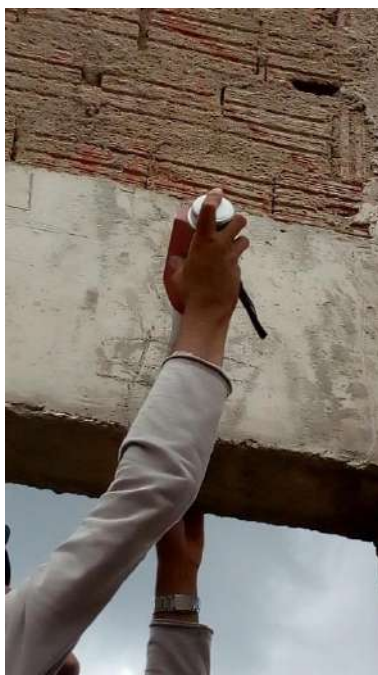
Fotografias n.º 187, 188 e 189 – ensaio de esclerometria da Laboratório V4, V5 e V6 (pavimento térreo) respectivamente.
