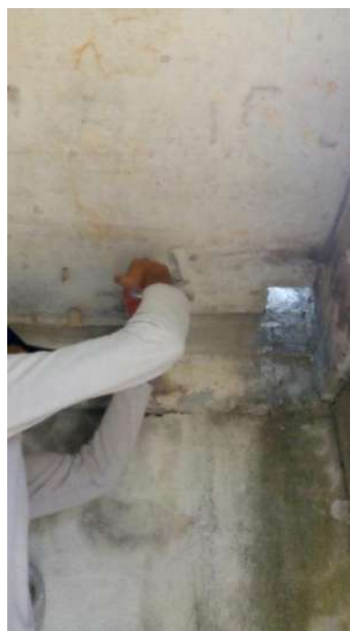
Fotografias n.º 153 e 154 – ensaio de esclerometria da Guarita V3 e V4 (pavimento térreo) respectivamente.
