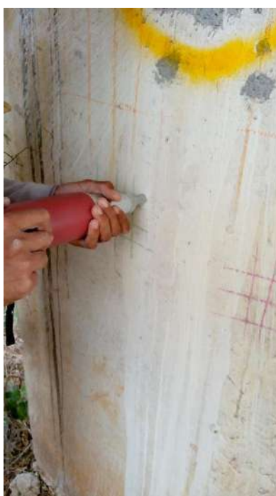
Fotografias n.º 233, 234, 235, 236, 237 e 238 – ensaio de esclerometria do Bloco Pedagógico P11, P12, P13, P14, P19 e P20 (pavimento térreo) respectivamente.
