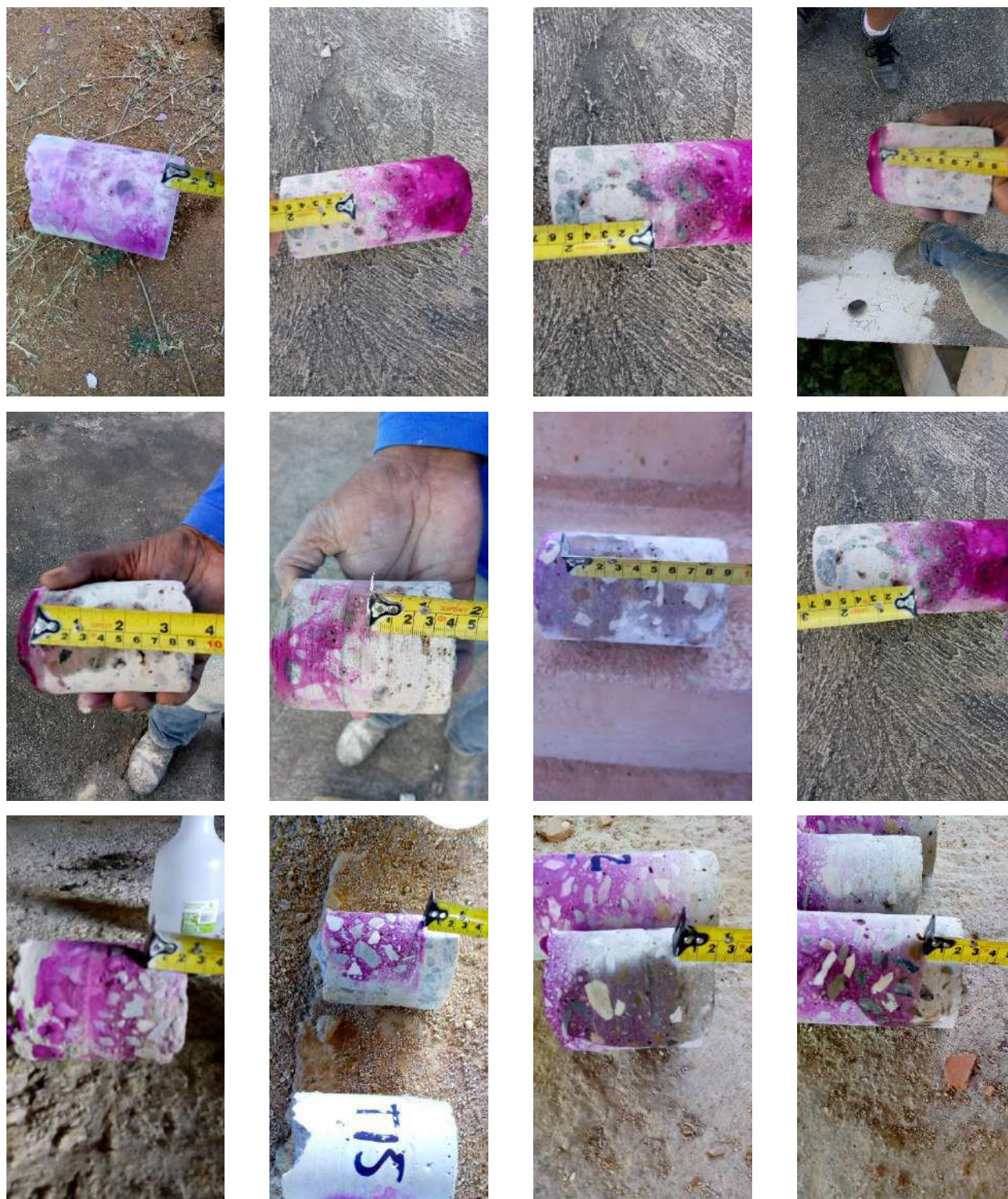
Fotografias n.º 634 a 645 – ensaio de profundidade de carbonatação T21 a T32, respectivamente.
