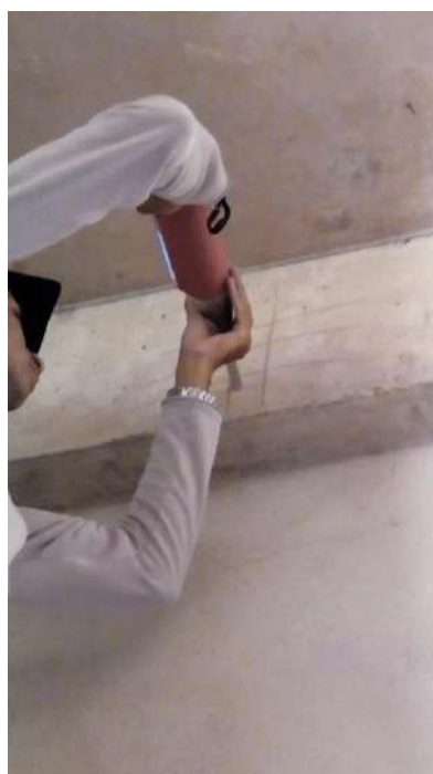
Fotografias n.º 107, 108, 109, 110, 111 e 112 – ensaio de esclerometria da Auditório P6, P7, P8, P9, V1 e V2 (pavimento térreo) respectivamente.
