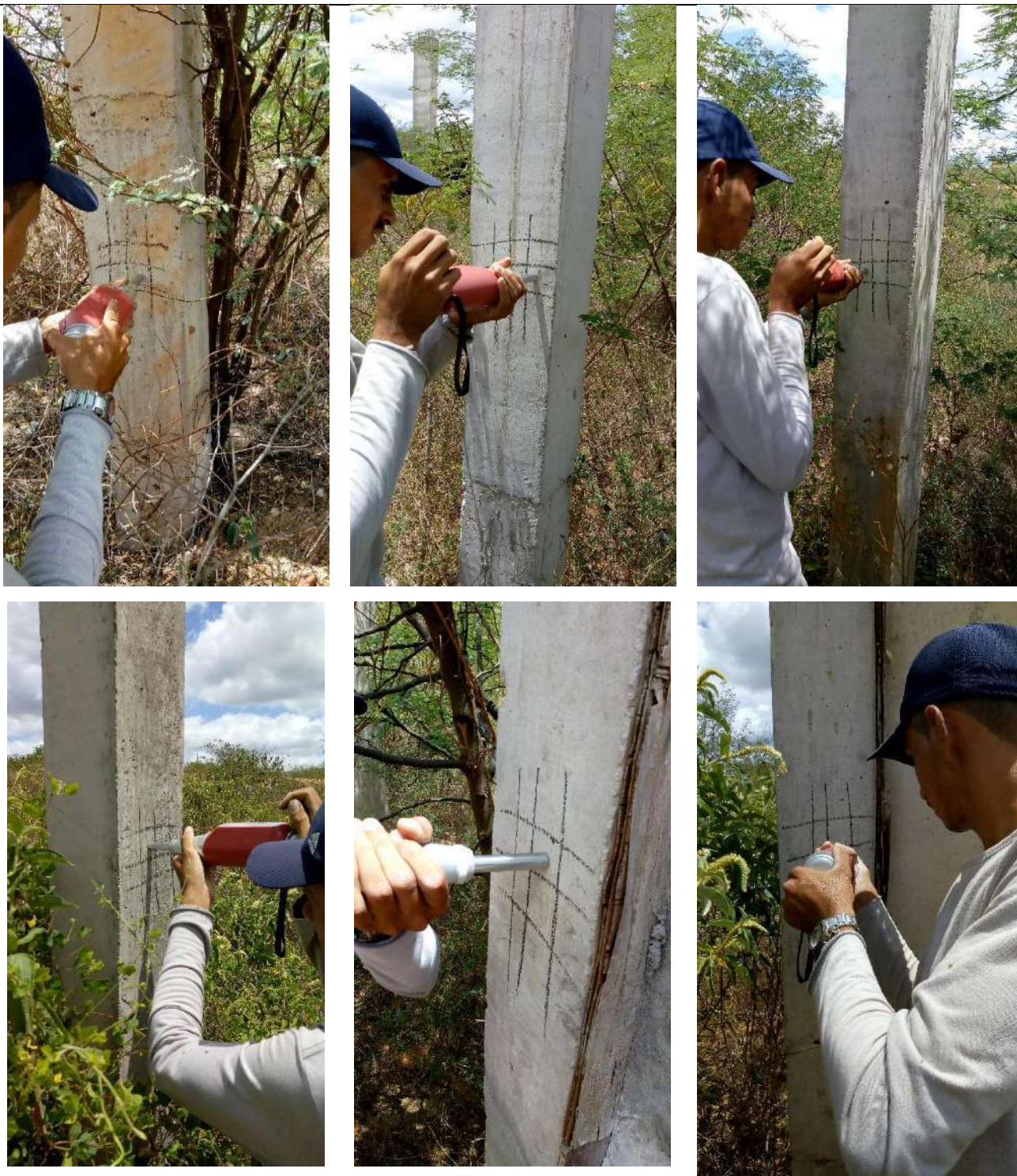
Fotografias n.º 193, 194, 195, 196, 197 e 198 – ensaio de esclerometria da Passarela P13, P14, P15, P16, P19 e P20 (pavimento térreo) respectivamente.
