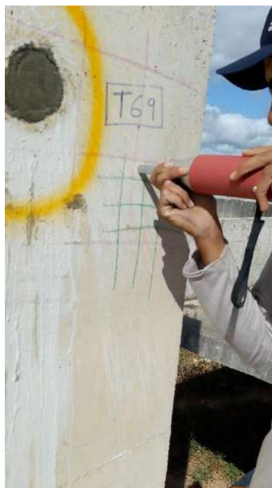
Fotografias n.º 293, 294, 295, 296, 297 e 298 – ensaio de esclerometria do Bloco Pedagógico P11, P12, P13, P14, P19 e P20 (pavimento superior) respectivamente.
