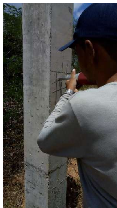
Fotografias n.º 190, 191 e 192 – ensaio de esclerometria da Passarela P10, P11 e P12 (pavimento térreo) respectivamente.
