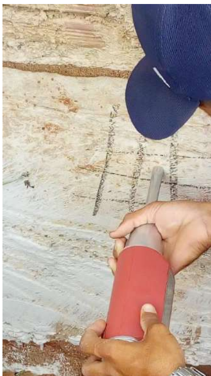
Fotografias n.º 153 e 154 – ensaio de esclerometria da Guarita V3 e V4 (pavimento térreo) respectivamente.
