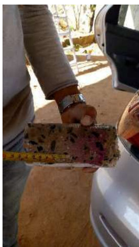
Fotografias n.º 682 a 687 – ensaio de profundidade de carbonatação, T89 a T93, respectivamente.
