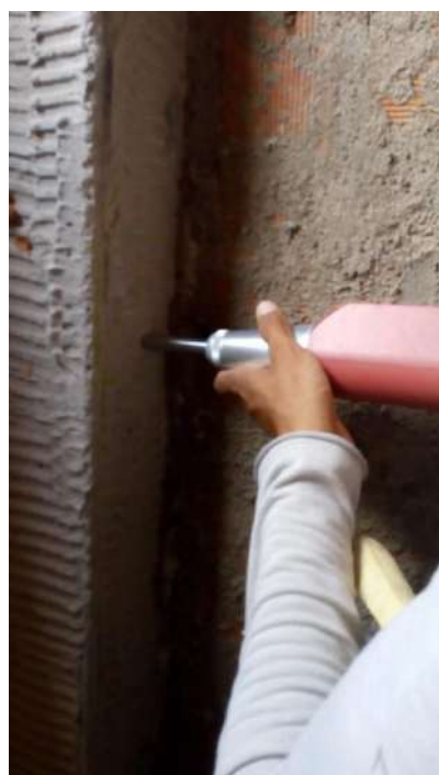
Fotografias n.º 101, 102, 103, 104, 105 E 106 – ensaio de esclerometria da Auditório V5 (pavimento fundação); P1, P2, P3, P4 e P5 (pavimento térreo) respectivamente.
