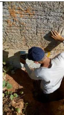
Fotografias n.º 452, 453 e 454 – ensaio de Pacometria, Sapata S14 (Vivencia – fundação); Sapata S5 (Ginásio – fundação); Viga Baldrame V1 (Laboratório – fundação);
