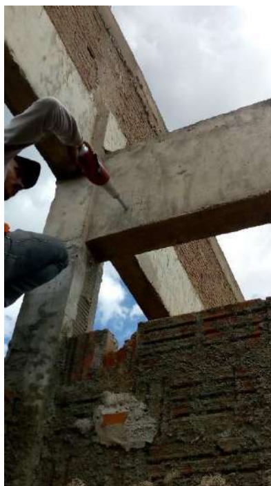
Fotografias n.º 181, 182, 183, 184, 185 e 186 – ensaio de esclerometria da Laboratório P19, P20, P21, V1, V2 e V3 (pavimento térreo) respectivamente.
