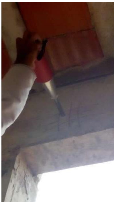
Fotografias n.º 181, 182, 183, 184, 185 e 186 – ensaio de esclerometria da Laboratório P19, P20, P21, V1, V2 e V3 (pavimento térreo) respectivamente.
