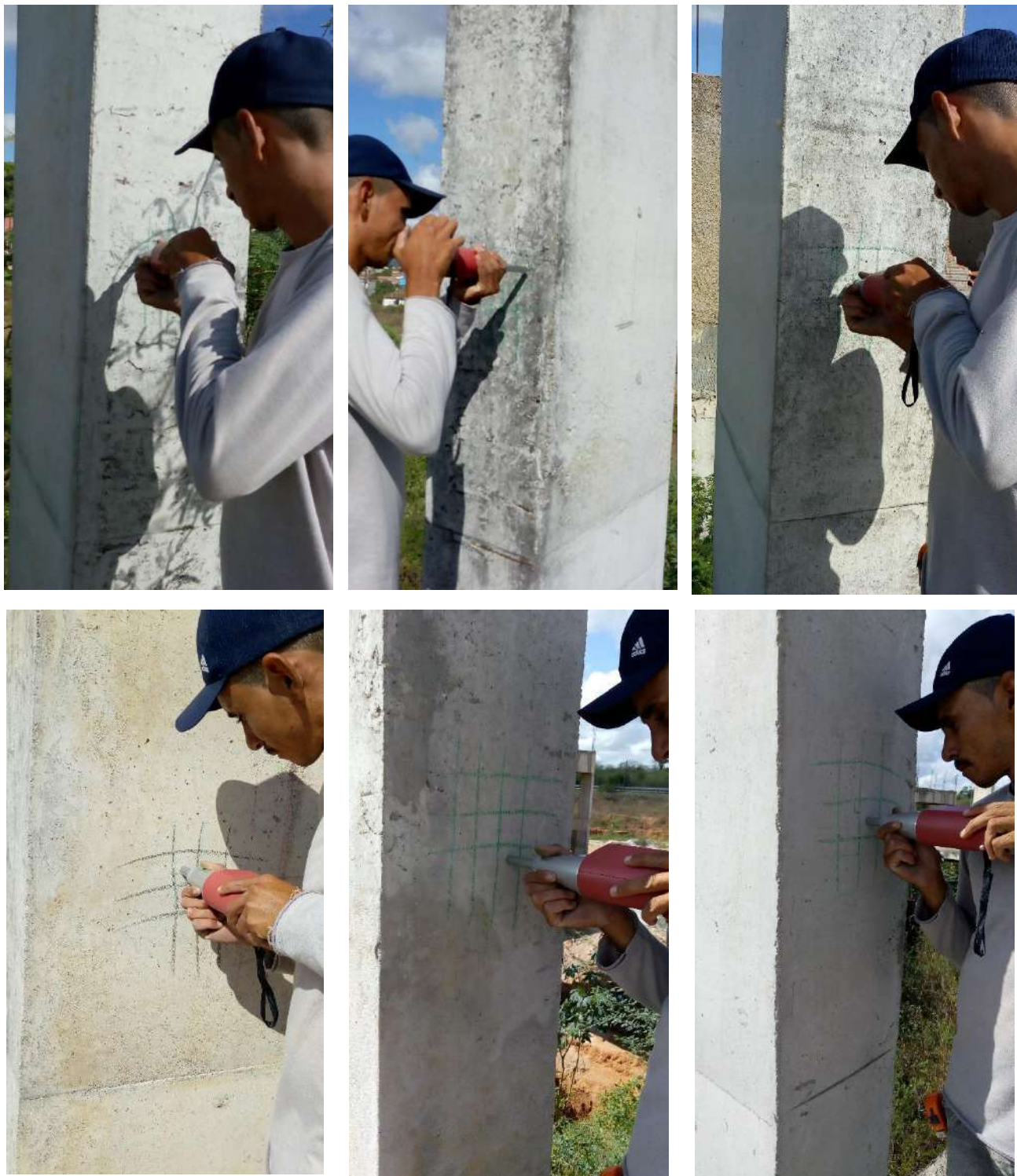
Fotografias n.º 287, 288, 289, 290, 291 e 292 – ensaio de esclerometria do Bloco Pedagógico P5, P6, P7, P8, P9 e P10 (pavimento superior) respectivamente.
