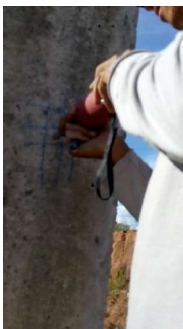
Fotografias n.º 130, 131, 132, 133, 134 e 135 – ensaio de esclerometria da Ginásio P12, P13, P14, P15, P16, P17 e P18 (pavimento térreo) respectivamente.
