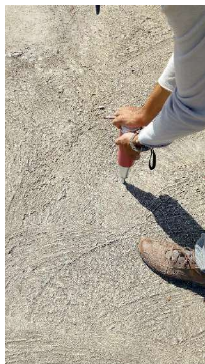
Fotografias n.º 269, 270, 271, 272, 273 e 274 – ensaio de esclerometria do Bloco Pedagógico L4, L5, L6, L7, L7A e L8 (pavimento térreo) respectivamente.
