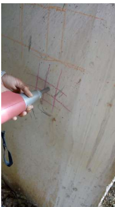
Fotografias n.º 233, 234, 235, 236, 237 e 238 – ensaio de esclerometria do Bloco Pedagógico P11, P12, P13, P14, P19 e P20 (pavimento térreo) respectivamente.
