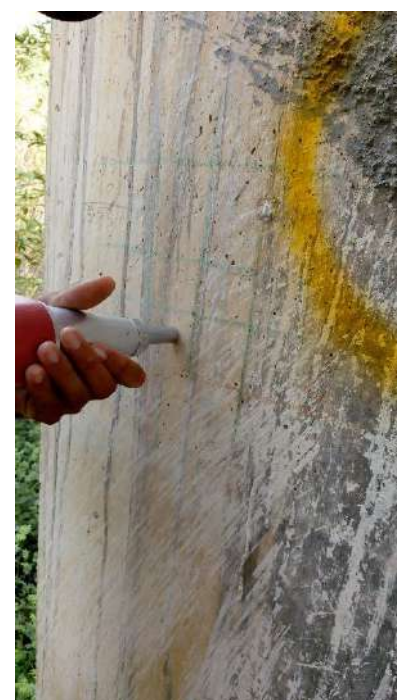
Fotografias n.º 233, 234, 235, 236, 237 e 238 – ensaio de esclerometria do Bloco Pedagógico P11, P12, P13, P14, P19 e P20 (pavimento térreo) respectivamente.
