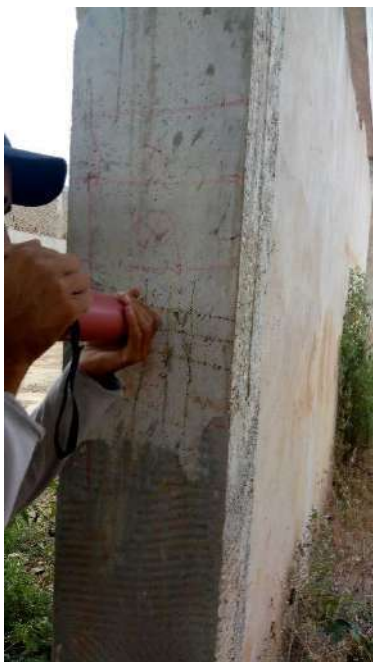
Fotografias n.º 170, 171, 172, 173, 174 e 175 – ensaio de esclerometria da Laboratório P7, P8, P9, P10, P11 e P12 (pavimento térreo) respectivamente.
