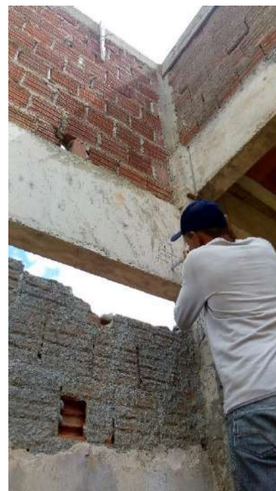
Fotografias n.º 181, 182, 183, 184, 185 e 186 – ensaio de esclerometria da Laboratório P19, P20, P21, V1, V2 e V3 (pavimento térreo) respectivamente.
