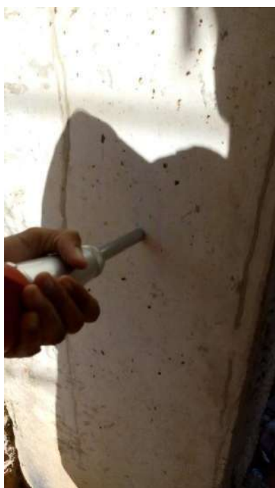
Fotografias n.º 59, 60, 61, 62, 63 e 64 – ensaio de esclerometria da Biblioteca, P1, P2, P3, P4, P5 e P6 (pavimento térreo) respectivamente.
