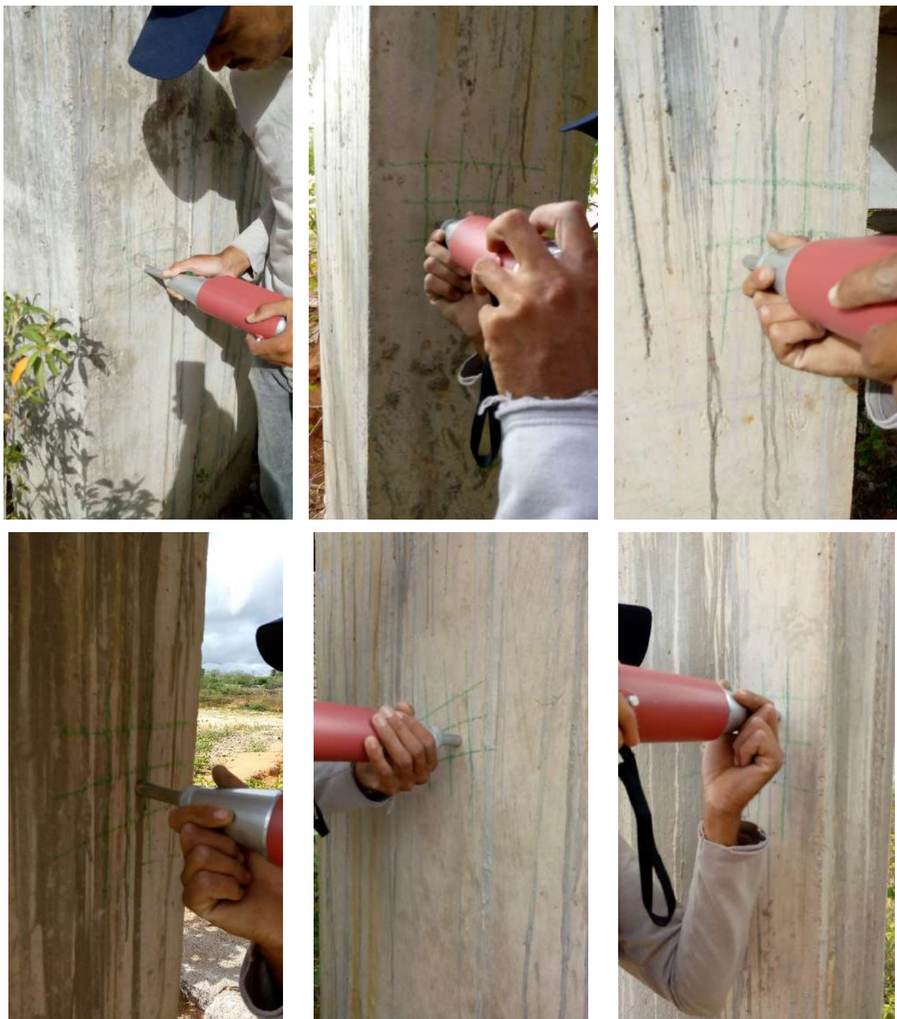
Fotografias n.º 245, 246, 247, 248, 249 e 250 – ensaio de esclerometria do Bloco Pedagógico P27, P28, P29, P30, P31 e P32 (pavimento térreo) respectivamente.
