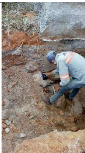
Fotografias n.º 452, 453 e 454 – ensaio de Pacometria, Sapata S14 (Vivencia – fundação); Sapata S5 (Ginásio – fundação); Viga Baldrame V1 (Laboratório – fundação);
