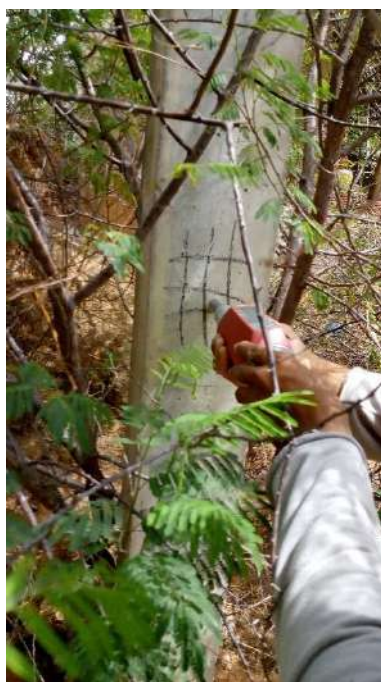
Fotografias n.º 176, 177, 178, 179, 180 e 181 – ensaio de esclerometria da Laboratório P13, P14, P15, P16, P17 e P18 (pavimento térreo) respectivamente.
