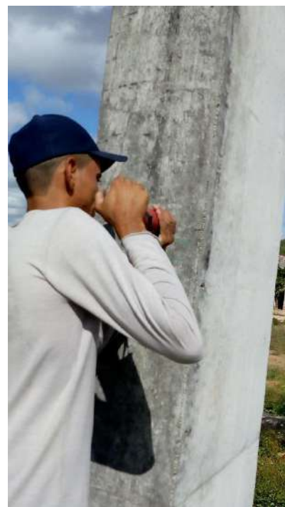
Fotografias n.º 281, 282, 283, 284, 285 e 286 – ensaio de esclerometria do Bloco Pedagógico L16, L17 (pavimento térreo) e P1, P2, P3 e P4 (pavimento superior) respectivamente.
