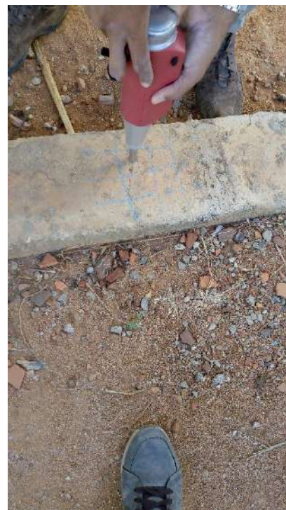
Fotografias n.º 95, 96, 97, 98, 99 e 100– ensaio de esclerometria da Auditório S15, S3, V1, V2, V3 e V4 (pavimento fundação) respectivamente.
