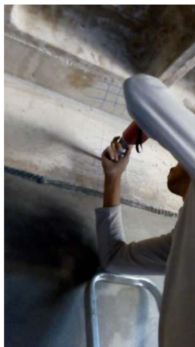
Fotografias n.º 353, 354, 355, 356 e 357 – ensaio de esclerometria da Vivência V5, V6, V7, V8 e V9 (pavimento térreo) respectivamente
