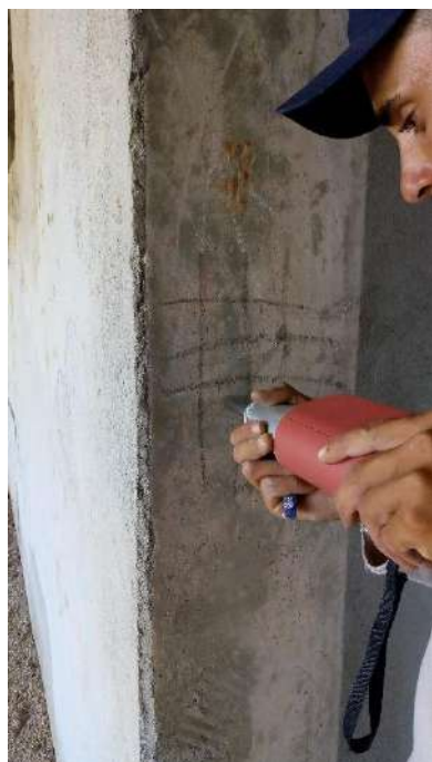
Fotografias n.º 335, 336, 337, 338, 339 e 340 – ensaio de esclerometria da Vivencia P16, P18, P19, P20, P21 e P22 (pavimento térreo) respectivamente
