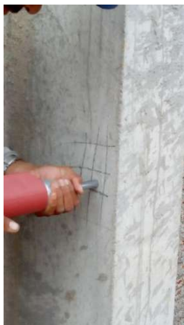
Fotografias n.º 164, 165, 166, 167, 168 e 169 – ensaio de esclerometria da Laboratório P1, P2, P3, P4, P5 e P6 (pavimento térreo) respectivamente.
