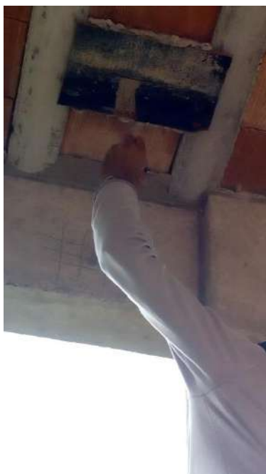
Fotografias n.º 187, 188 e 189 – ensaio de esclerometria da Laboratório V4, V5 e V6 (pavimento térreo) respectivamente.
