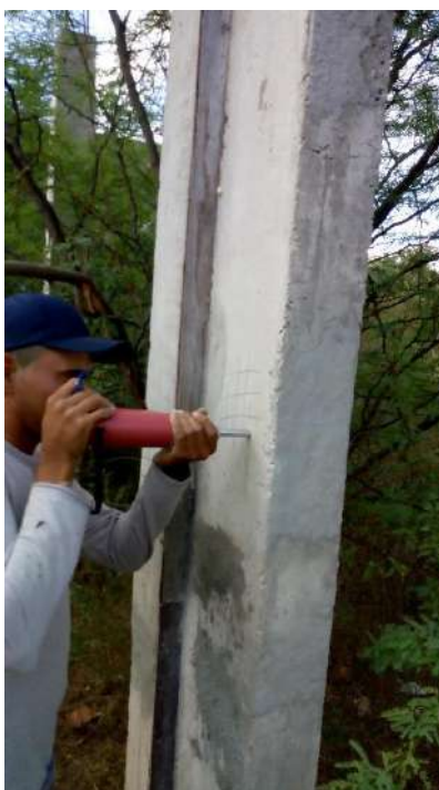
Fotografias n.º 323, 324, 325, 326, 327 e 328 – ensaio de esclerometria da Vivência V14, V15 (pavimento fundação) e P1, P2, P3 e P4 (pavimento térreo) respectivamente.
