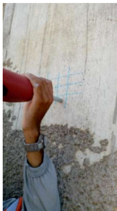
Fotografias n.º 59, 60, 61, 62, 63 e 64 – ensaio de esclerometria da Biblioteca, P1, P2, P3, P4, P5 e P6 (pavimento térreo) respectivamente.
