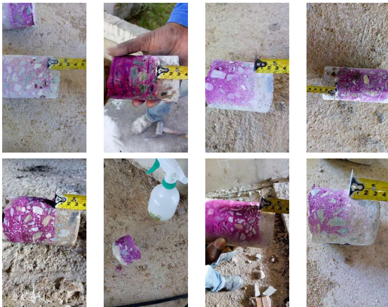
Fotografias n.º 610 a 621 – ensaio de profundidade de carbonatação T1 a T8, respectivamente.
