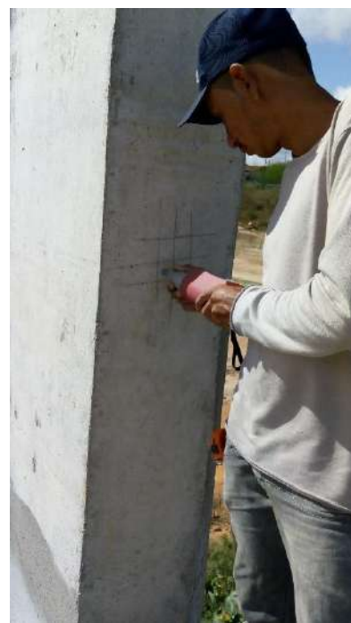
Fotografias n.º 299, 300, 301, 302, 303 e 304 – ensaio de esclerometria do Bloco Pedagógico P21, P22, P23, P24, P25 e P27 (pavimento superior) respectivamente.
