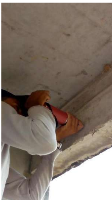
Fotografias n.º 153 e 154 – ensaio de esclerometria da Guarita V3 e V4 (pavimento térreo) respectivamente.
