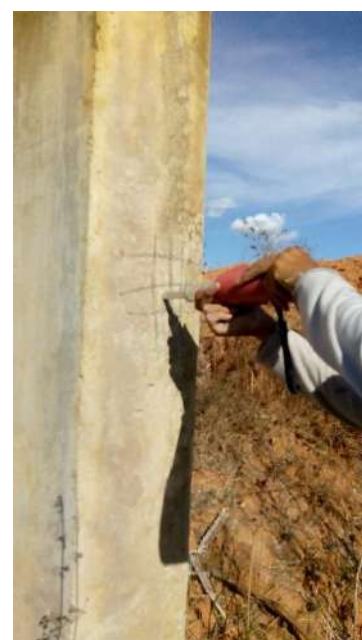
Fotografias n.º 130, 131, 132, 133, 134 e 135 – ensaio de esclerometria da Ginásio P12, P13, P14, P15, P16, P17 e P18 (pavimento térreo) respectivamente.
