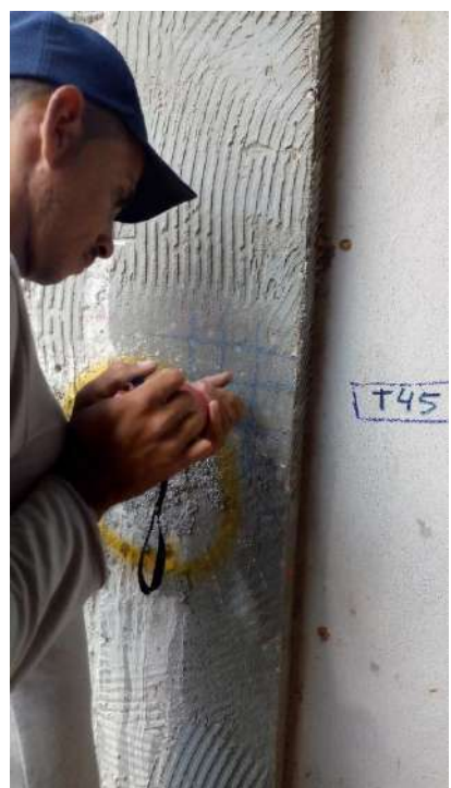
Fotografias n.º 329, 330, 331, 332, 333 e 334 – ensaio de esclerometria da Vivencia P5, P6, P9, P10, P11 e P14 (pavimento térreo) respectivamente
