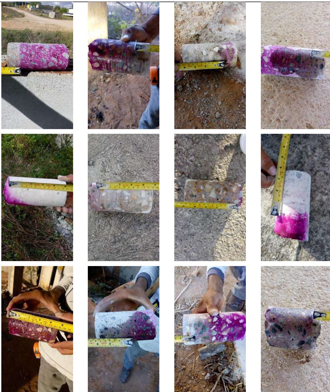
Fotografias n.º 658 a 669 – ensaio de profundidade de carbonatação, T49, T50, T51, T68 a T76, respectivamente.
