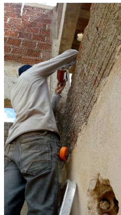
Fotografias n.º 176, 177, 178, 179, 180 e 181 – ensaio de esclerometria da Laboratório P13, P14, P15, P16, P17 e P18 (pavimento térreo) respectivamente.
