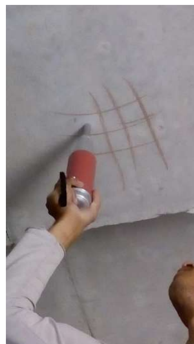
Fotografias n.º 107, 108, 109, 110, 111 e 112 – ensaio de esclerometria da Auditório P6, P7, P8, P9, V1 e V2 (pavimento térreo) respectivamente.
