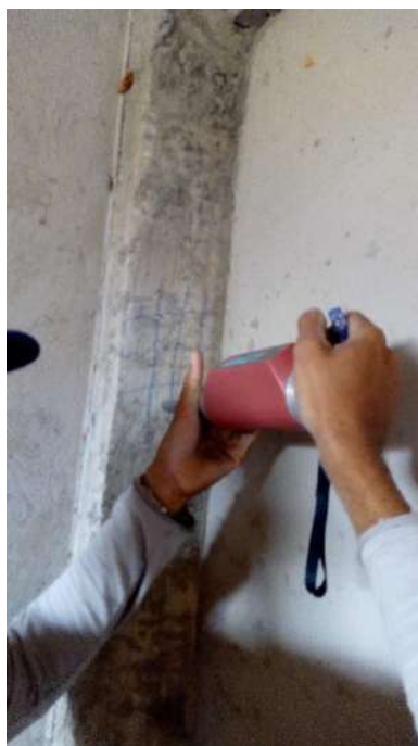
Fotografias n.º 335, 336, 337, 338, 339 e 340 – ensaio de esclerometria da Vivencia P16, P18, P19, P20, P21 e P22 (pavimento térreo) respectivamente
