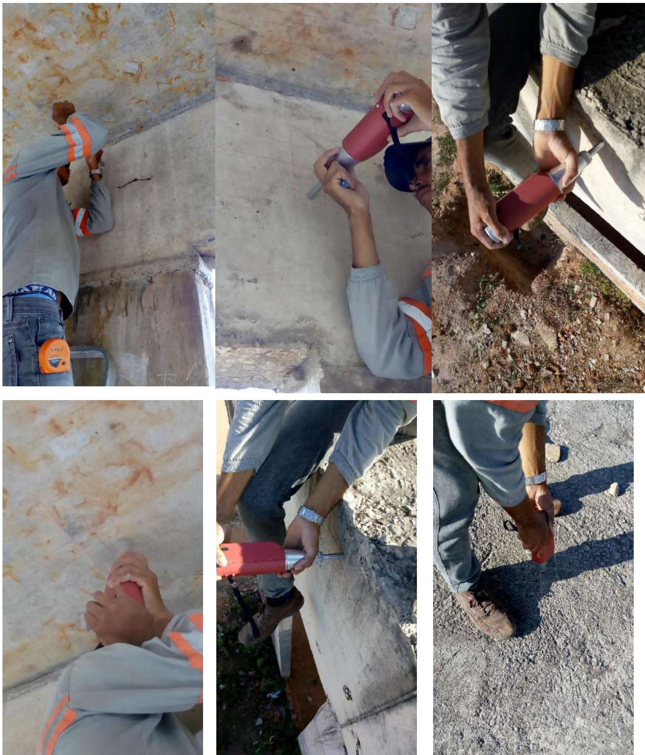
Fotografias n.º 89, 90, 91, 92, 93 e 94 – ensaio de esclerometria da Biblioteca V1, V2, V3, V4, V5 e L1 (pavimento superior) respectivamente.
