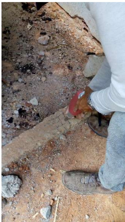
Fotografias n.º 311, 312, 313, 314, 315 e 316 – ensaio de esclerometria da Vivência S14, S32, V1, V2, V3 e V4 (pavimento fundação) respectivamente.
