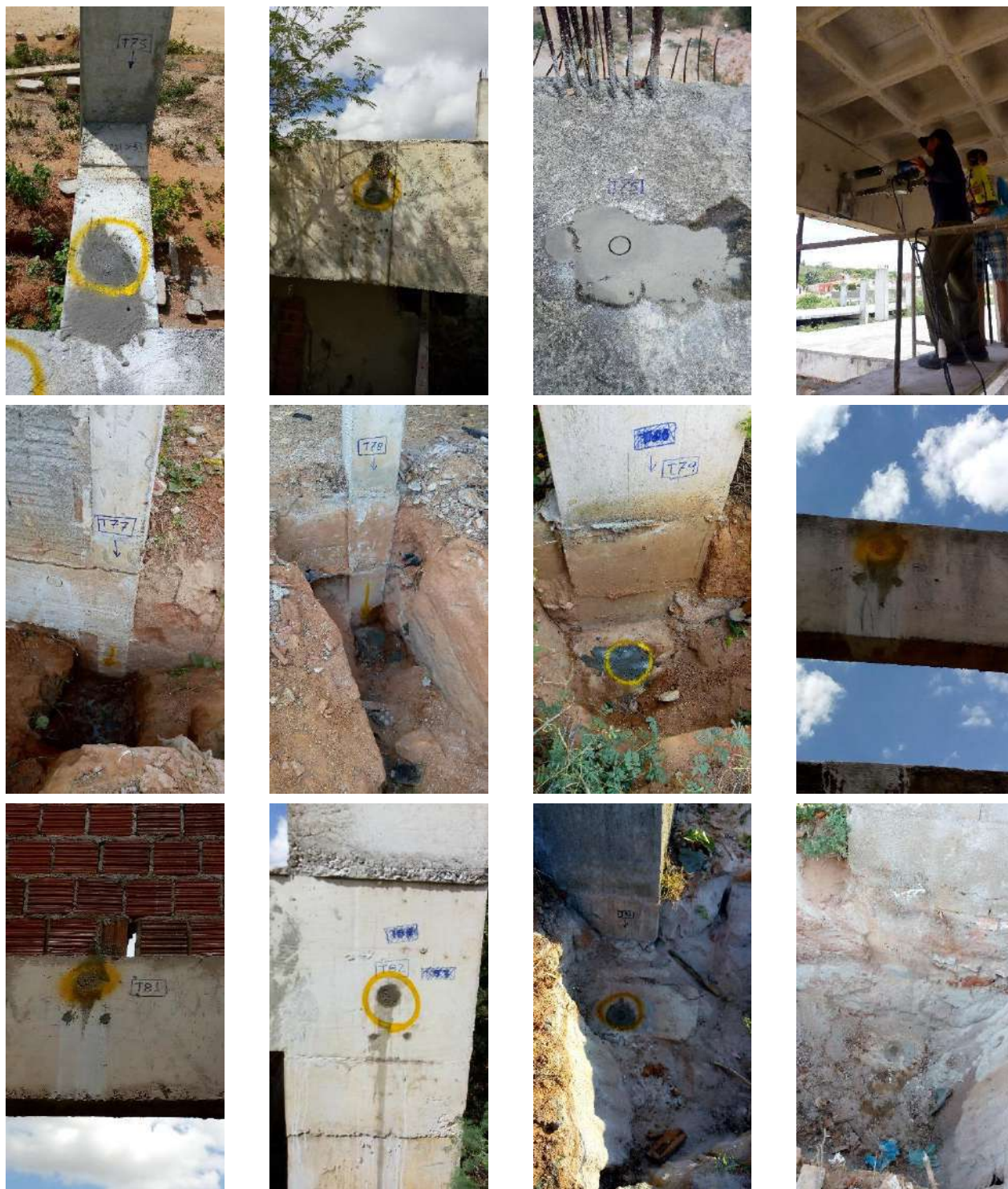
Fotografias n.º 544 a 555 – extração de testemunhos no Bloco Pedagógico (T73, T74, T79), Biblioteca (T75, T76, T83, T84) e Laboratório (T77, T78, T80, T81).
