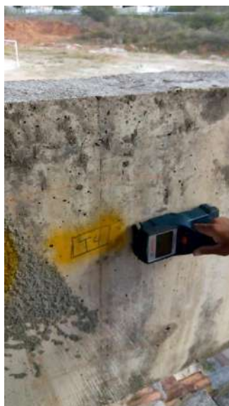
Fotografias n.º 361, 362, 363, 364, 365 e 366 – ensaio de Pacometria, Pilar P26 (Bloco Pedagógico - térreo), Pilar PC1, Viga V3, Viga V2, Pilar P6 e Pilar P7 (Biblioteca – térreo) respectivamente
