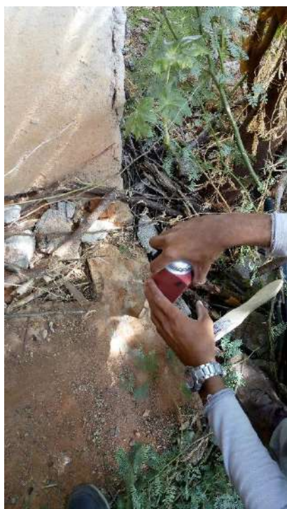
Fotografias n.º 317, 318, 319, 320, 321 e 322 – ensaio de esclerometria da Vivência V5, V6, V7, V8, V9 e V11 (pavimento fundação) respectivamente.
