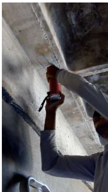
Fotografias n.º 347, 348, 349, 350, 351 e 352 – ensaio de esclerometria da Vivência L5, L6, L7, L8, V3 e V4 (pavimento térreo) respectivamente
