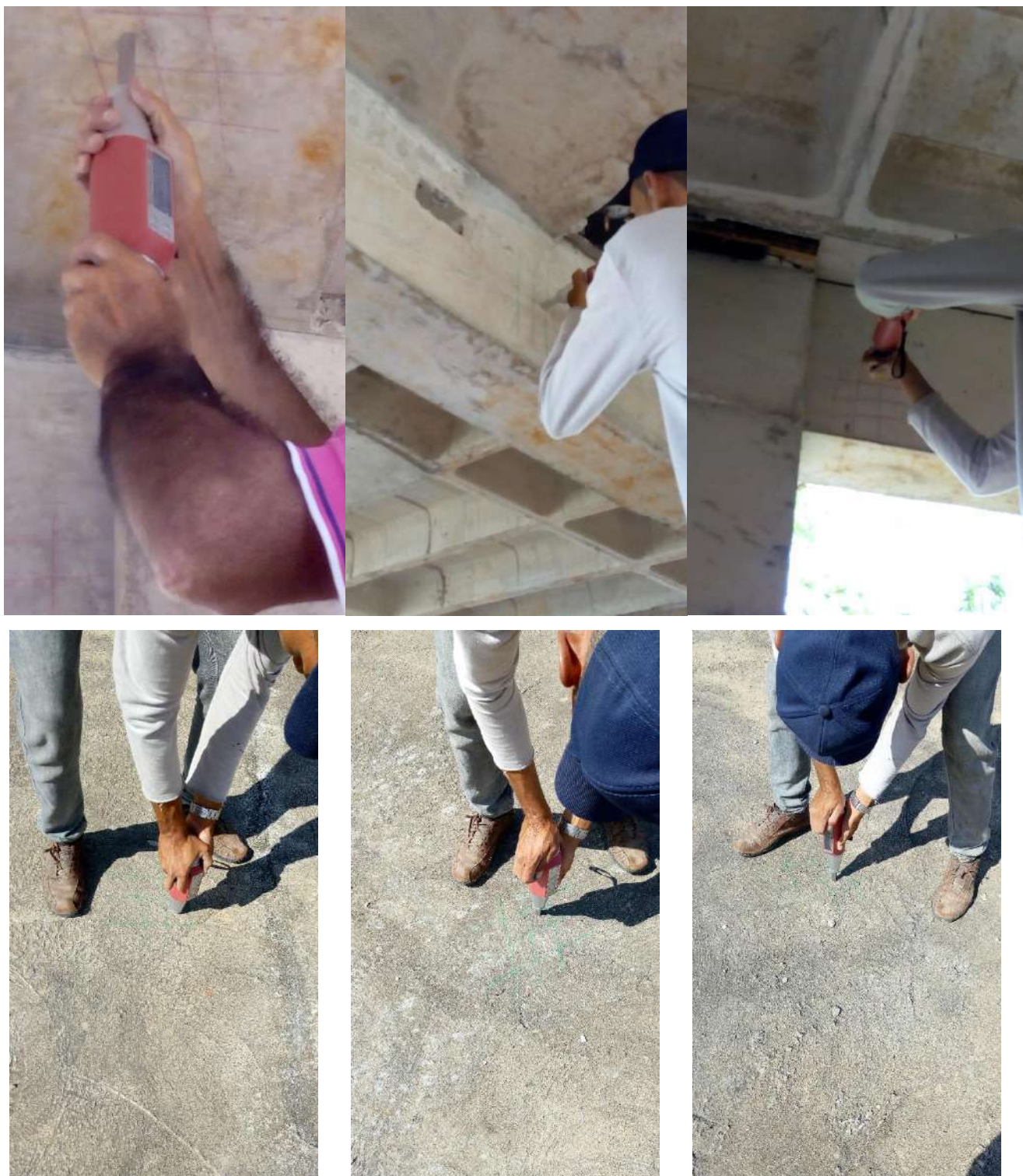
Fotografias n.º263, 264, 265, 266, 267 e 268 – ensaio de esclerometria do Bloco Pedagógico V15, V16, V17, L1, L2 e L3 (pavimento térreo) respectivamente.
