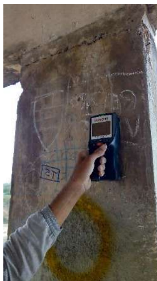
Fotografias n.º 361, 362, 363, 364, 365 e 366 – ensaio de Pacometria, Pilar P26 (Bloco Pedagógico - térreo), Pilar PC1, Viga V3, Viga V2, Pilar P6 e Pilar P7 (Biblioteca – térreo) respectivamente
