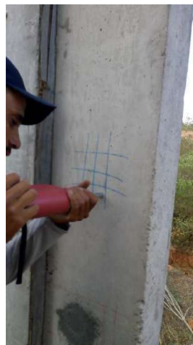
Fotografias n.º 323, 324, 325, 326, 327 e 328 – ensaio de esclerometria da Vivência V14, V15 (pavimento fundação) e P1, P2, P3 e P4 (pavimento térreo) respectivamente.
