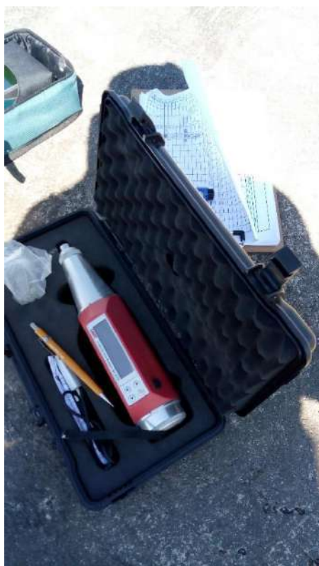
Fotografias n.º 50 e 51 – apresentação do Esclerômetro digital SADT HT-225D.
