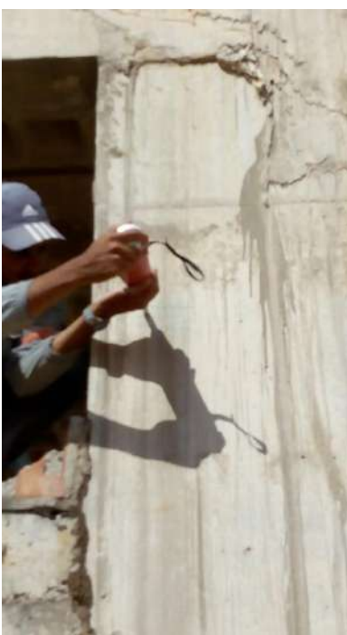
Fotografias n.º 59, 60, 61, 62, 63 e 64 – ensaio de esclerometria da Biblioteca, P1, P2, P3, P4, P5 e P6 (pavimento térreo) respectivamente.
