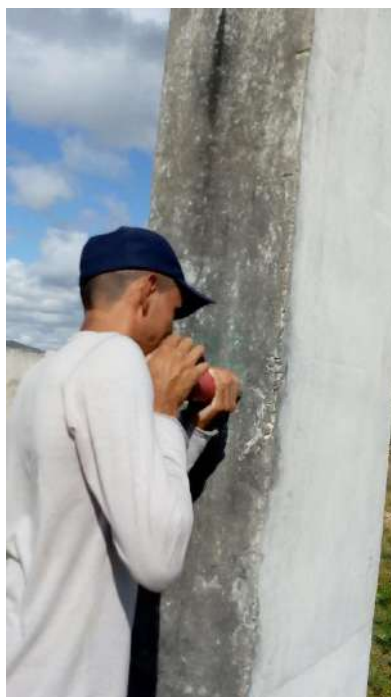
Fotografias n.º 281, 282, 283, 284, 285 e 286 – ensaio de esclerometria do Bloco Pedagógico L16, L17 (pavimento térreo) e P1, P2, P3 e P4 (pavimento superior) respectivamente.
