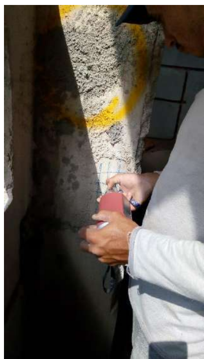
Fotografias n.º 329, 330, 331, 332, 333 e 334 – ensaio de esclerometria da Vivencia P5, P6, P9, P10, P11 e P14 (pavimento térreo) respectivamente
