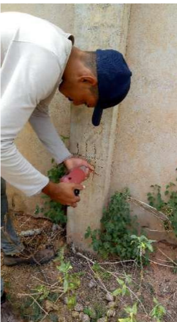
Fotografias n.º 170, 171, 172, 173, 174 e 175 – ensaio de esclerometria da Laboratório P7, P8, P9, P10, P11 e P12 (pavimento térreo) respectivamente.
