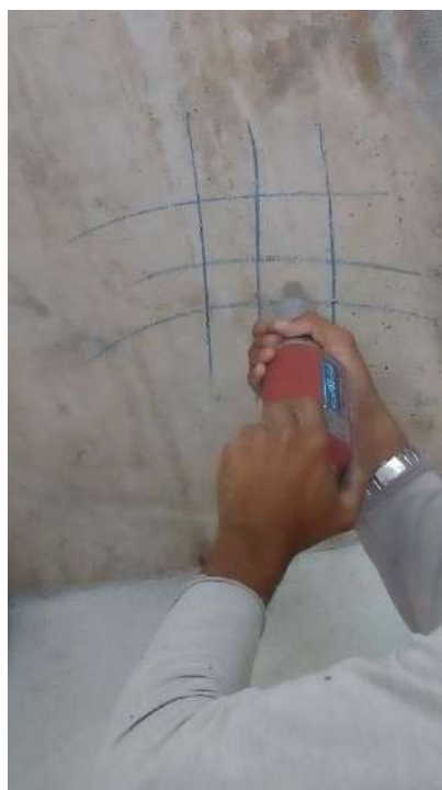
Fotografias n.º 341, 342, 343, 344, 345 e 346 – ensaio de esclerometria da Vivência P31, P32, L1, L2, L3 e L4 (pavimento térreo) respectivamente
