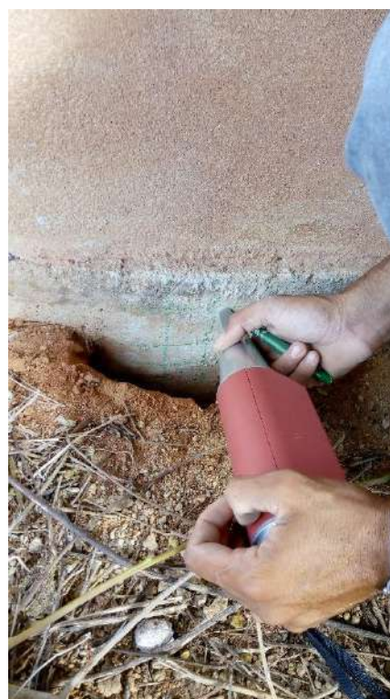
Fotografias n.º 206, 207 e 208 – ensaio de esclerometria do Bloco Pedagógico S4, S9 e V1 (pavimento fundação) respectivamente.
