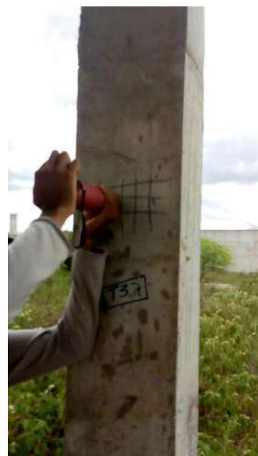
Fotografias n.º 164, 165, 166, 167, 168 e 169 – ensaio de esclerometria da Laboratório P1, P2, P3, P4, P5 e P6 (pavimento térreo) respectivamente.
