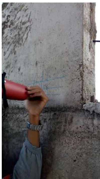
Fotografias n.º 77, 78, 79, 80, 81 e 82 – ensaio de esclerometria da Biblioteca, P1, P2, P3, P4, P5 e P6 (pavimento superior) respectivamente.
