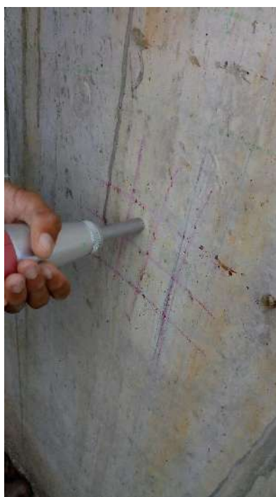
Fotografias n.º 221, 222, 223, 224, 225 e 226 – ensaio de esclerometria do Bloco Pedagógico V16, V17 (pavimento fundação) e P1, P2, P3, P4 (pavimento térreo) respectivamente.
