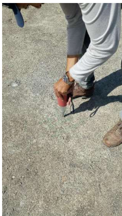
Fotografias n.º 269, 270, 271, 272, 273 e 274 – ensaio de esclerometria do Bloco Pedagógico L4, L5, L6, L7, L7A e L8 (pavimento térreo) respectivamente.
