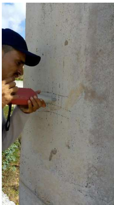
Fotografias n.º 299, 300, 301, 302, 303 e 304 – ensaio de esclerometria do Bloco Pedagógico P21, P22, P23, P24, P25 e P27 (pavimento superior) respectivamente.
