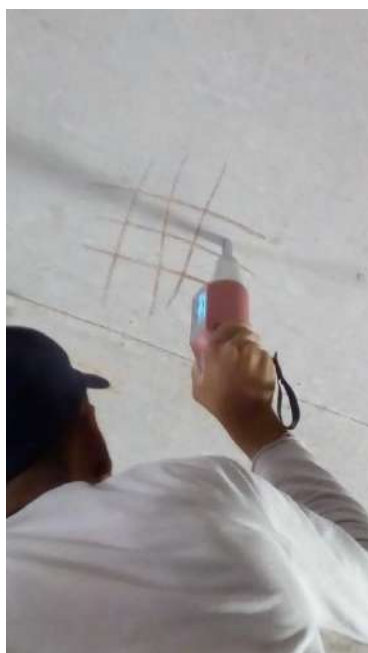
Fotografias n.º119, 120, 121, 122 e 123 – ensaio de esclerometria da Auditório L1, L2, L3, L4 e L5 (pavimento térreo) respectivamente.
