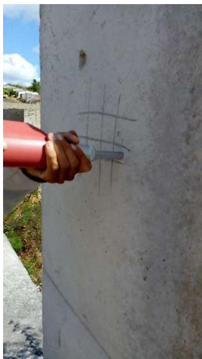
Fotografias n.º 293, 294, 295, 296, 297 e 298 – ensaio de esclerometria do Bloco Pedagógico P11, P12, P13, P14, P19 e P20 (pavimento superior) respectivamente.
