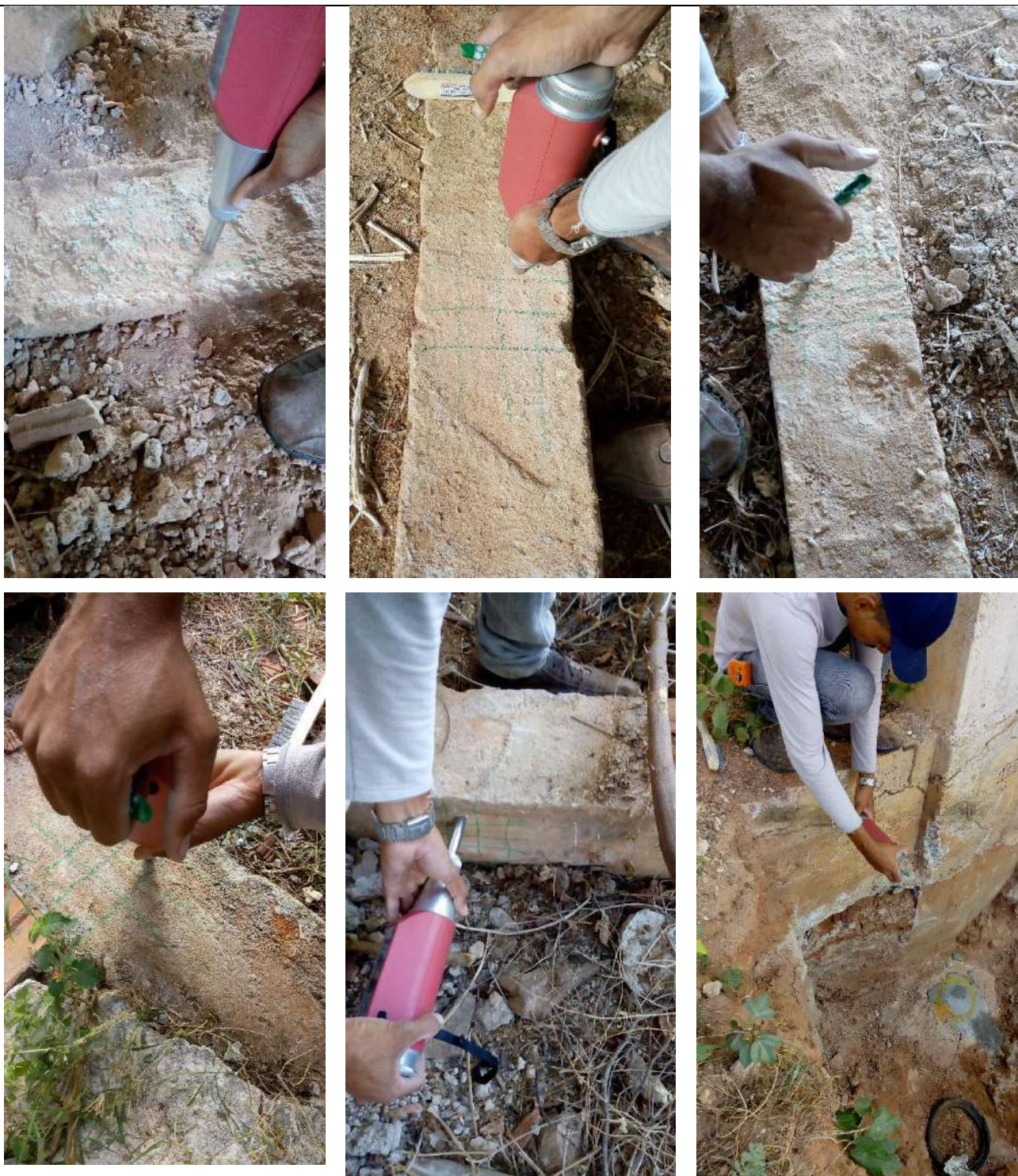
Fotografias n.º 209, 210, 211, 212, 213 e 214 – ensaio de esclerometria do Bloco Pedagógico V2, V3, V4, V5, V6 e V7 (pavimento fundação) respectivamente.
