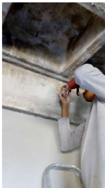
Fotografias n.º 347, 348, 349, 350, 351 e 352 – ensaio de esclerometria da Vivência L5, L6, L7, L8, V3 e V4 (pavimento térreo) respectivamente
