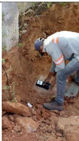
Fotografias n.º 452, 453 e 454 – ensaio de Pacometria, Sapata S14 (Vivencia – fundação); Sapata S5 (Ginásio – fundação); Viga Baldrame V1 (Laboratório – fundação);
