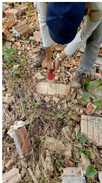
Fotografias n.º 153 e 154 – ensaio de esclerometria da Guarita V3 e V4 (pavimento térreo) respectivamente.
