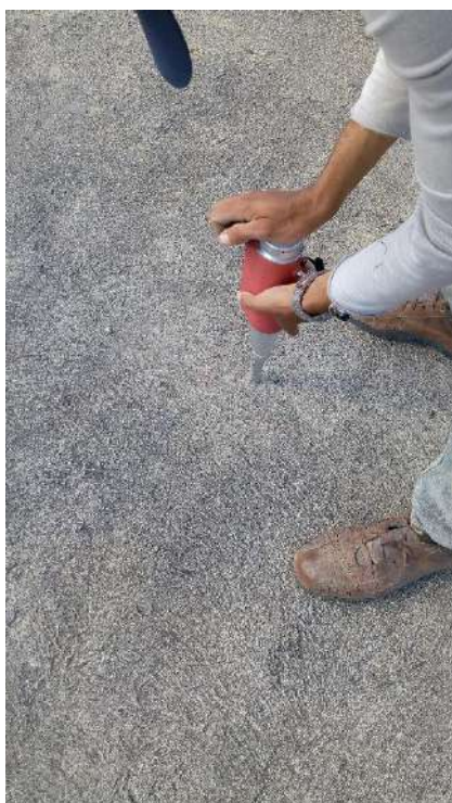
Fotografias n.º 275, 276, 277, 278, 279 e 280 – ensaio de esclerometria do Bloco Pedagógico L9, L10, L11, L12, L13 e L14 (pavimento térreo) respectivamente.
