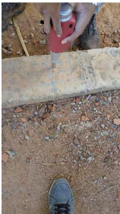
Fotografias n.º 53, 54, 54, 55, 56, 57 e 28 – ensaio de esclerometria da Biblioteca, vigas V1, V2, V3, V4, S1 e S5 (pavimento fundação) respectivamente.
