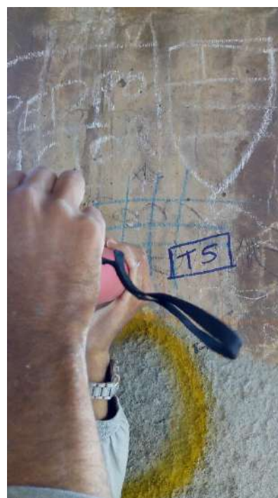
Fotografias n.º 77, 78, 79, 80, 81 e 82 – ensaio de esclerometria da Biblioteca, P1, P2, P3, P4, P5 e P6 (pavimento superior) respectivamente.
