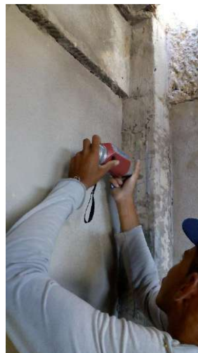
Fotografias n.º 335, 336, 337, 338, 339 e 340 – ensaio de esclerometria da Vivencia P16, P18, P19, P20, P21 e P22 (pavimento térreo) respectivamente
