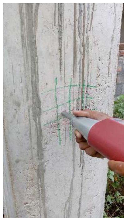
Fotografias n.º 221, 222, 223, 224, 225 e 226 – ensaio de esclerometria do Bloco Pedagógico V16, V17 (pavimento fundação) e P1, P2, P3, P4 (pavimento térreo) respectivamente.
