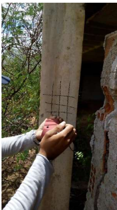
Fotografias n.º 190, 191 e 192 – ensaio de esclerometria da Passarela P10, P11 e P12 (pavimento térreo) respectivamente.
