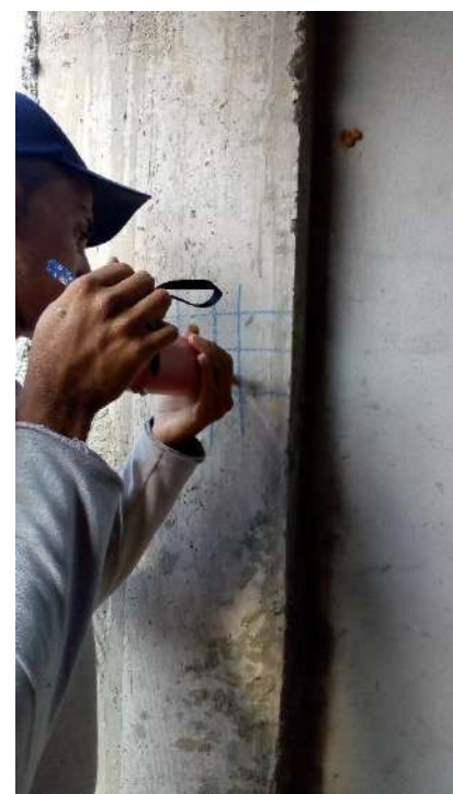
Fotografias n.º 329, 330, 331, 332, 333 e 334 – ensaio de esclerometria da Vivencia P5, P6, P9, P10, P11 e P14 (pavimento térreo) respectivamente
