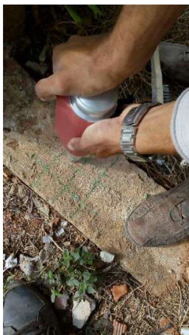
Fotografias n.º 215, 216, 217, 218, 219 a 220 – ensaio de esclerometria do Bloco Pedagógico V9, V10, V11, V12, V13 e V14 (pavimento fundação) respectivamente.
