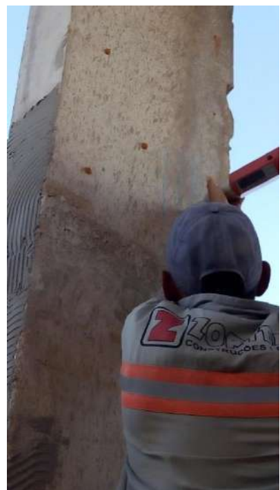
Fotografias n.º 83, 84, 85, 86, 87 e 88 – ensaio de esclerometria da Biblioteca, P7, P8, PC1, PC2, PC3 e L2 (pavimento superior) respectivamente.
