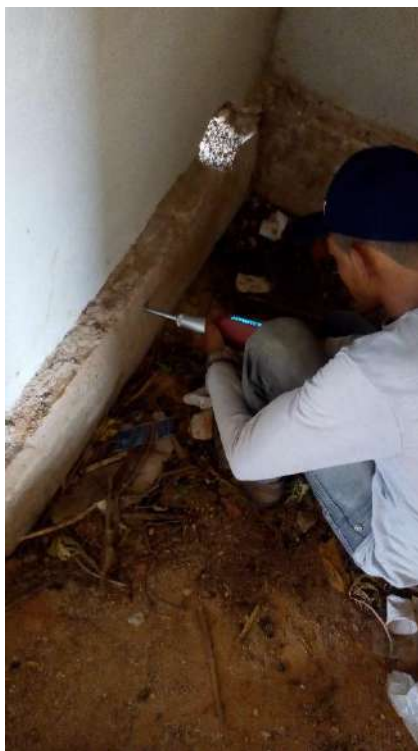
Fotografias n.º 311, 312, 313, 314, 315 e 316 – ensaio de esclerometria da Vivência S14, S32, V1, V2, V3 e V4 (pavimento fundação) respectivamente.
