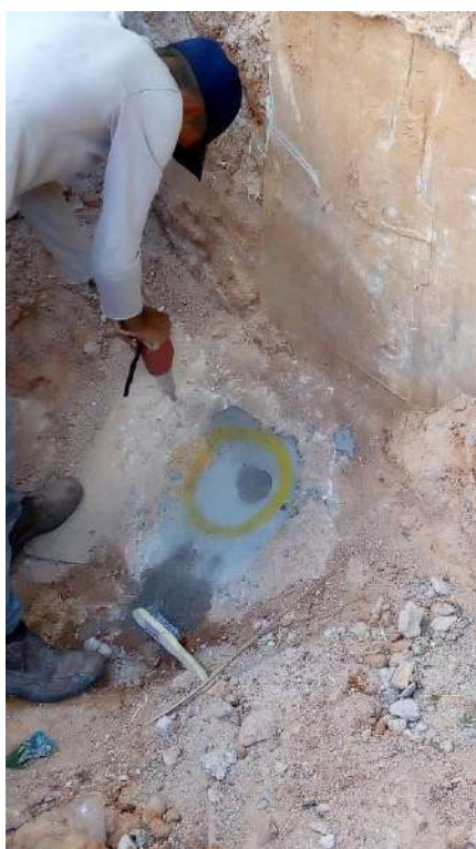
Fotografias n.º 206, 207 e 208 – ensaio de esclerometria do Bloco Pedagógico S4, S9 e V1 (pavimento fundação) respectivamente.
