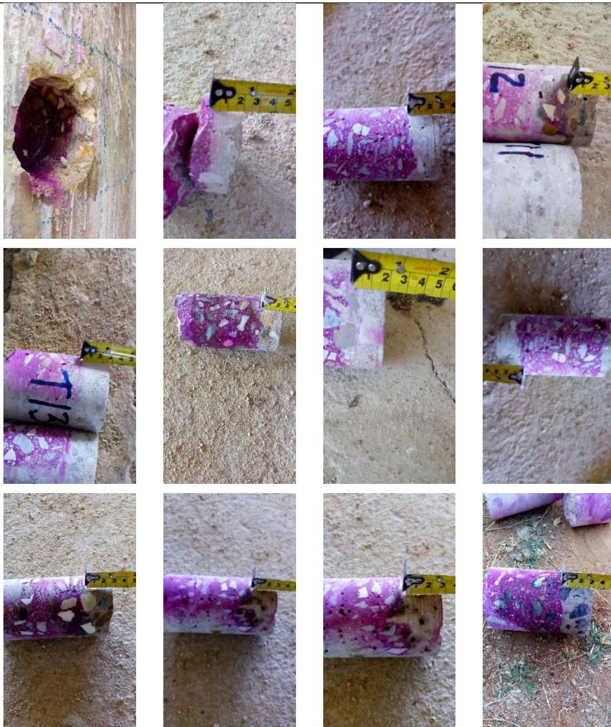
Fotografias n.º 622 a 633 – ensaio de profundidade de carbonatação T9 a T20, respectivamente.
