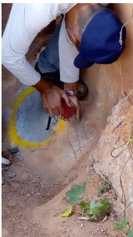
Fotografias n.º 206, 207 e 208 – ensaio de esclerometria do Bloco Pedagógico S4, S9 e V1 (pavimento fundação) respectivamente.
