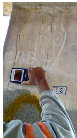
Fotografias n.º 361, 362, 363, 364, 365 e 366 – ensaio de Pacometria, Pilar P26 (Bloco Pedagógico - térreo), Pilar PC1, Viga V3, Viga V2, Pilar P6 e Pilar P7 (Biblioteca – térreo) respectivamente
