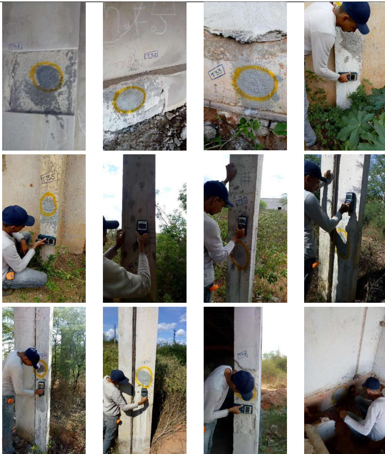
Fotografias n.º 391 a 402 – ensaio de Pacometria, Pilar P5 (Auditório – térreo); Viga Baldrame V3 e V4 (Auditório – fundação); Pilares P15, P19, P9 e P14 (Laboratório - térreo); Pilar P20 (Vivencia – térreo); Pilar P21 (Passarela – térreo); Pilar P22 e P41 (Vivencia – térreo); Viga Baldrame V4 (Vivencia – fundação).
