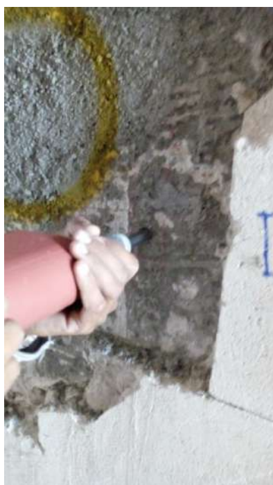
Fotografias n.º 107, 108, 109, 110, 111 e 112 – ensaio de esclerometria da Auditório P6, P7, P8, P9, V1 e V2 (pavimento térreo) respectivamente.
