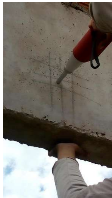
Fotografias n.º 187, 188 e 189 – ensaio de esclerometria da Laboratório V4, V5 e V6 (pavimento térreo) respectivamente.
