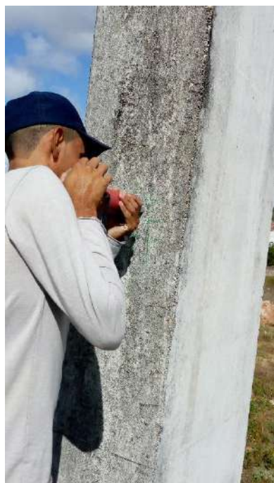
Fotografias n.º 281, 282, 283, 284, 285 e 286 – ensaio de esclerometria do Bloco Pedagógico L16, L17 (pavimento térreo) e P1, P2, P3 e P4 (pavimento superior) respectivamente.
