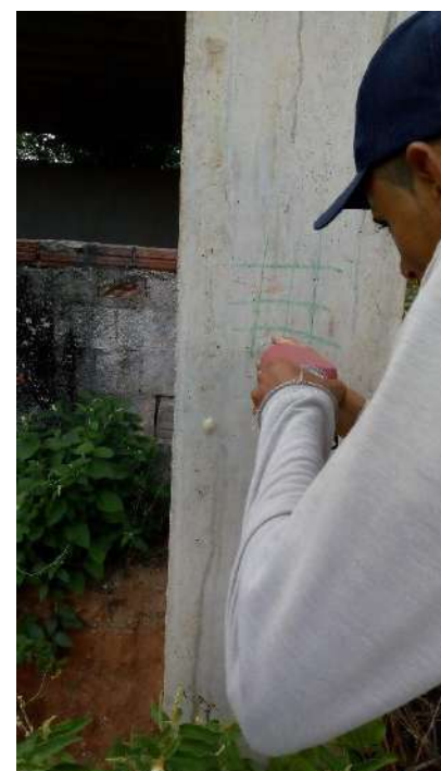
Fotografias n.º 221, 222, 223, 224, 225 e 226 – ensaio de esclerometria do Bloco Pedagógico V16, V17 (pavimento fundação) e P1, P2, P3, P4 (pavimento térreo) respectivamente.
