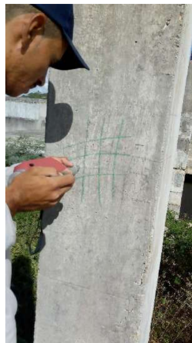
Fotografias n.º 293, 294, 295, 296, 297 e 298 – ensaio de esclerometria do Bloco Pedagógico P11, P12, P13, P14, P19 e P20 (pavimento superior) respectivamente.
