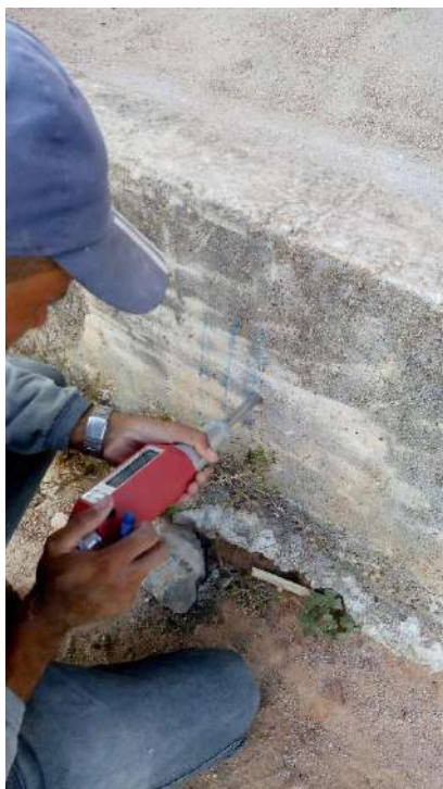
Fotografias n.º 95, 96, 97, 98, 99 e 100– ensaio de esclerometria da Auditório S15, S3, V1, V2, V3 e V4 (pavimento fundação) respectivamente.
