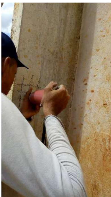
Fotografias n.º 176, 177, 178, 179, 180 e 181 – ensaio de esclerometria da Laboratório P13, P14, P15, P16, P17 e P18 (pavimento térreo) respectivamente.
