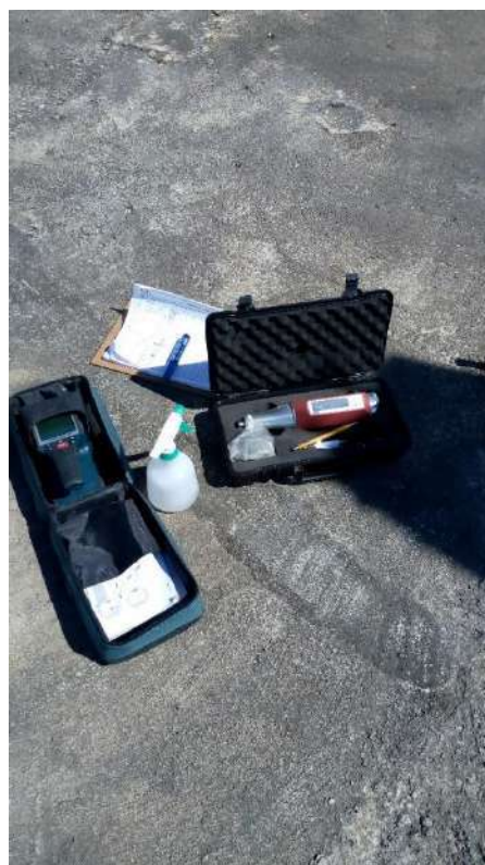
Fotografias n.º 50 e 51 – apresentação do Esclerômetro digital SADT HT-225D.
