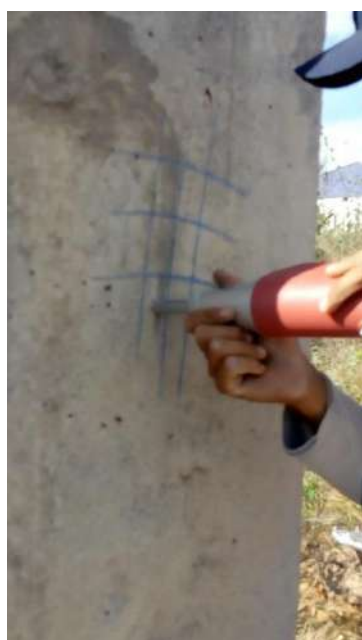
Fotografias n.º 130, 131, 132, 133, 134 e 135 – ensaio de esclerometria da Ginásio P12, P13, P14, P15, P16, P17 e P18 (pavimento térreo) respectivamente.
