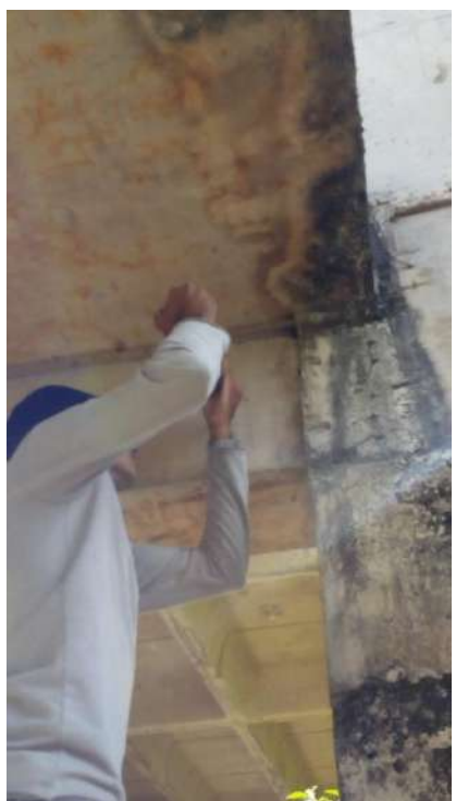
Fotografias n.º 251, 252, 253, 254, 255 e 256 – ensaio de esclerometria do Bloco Pedagógico V1, V2, V5, V6, V7 e V8 (pavimento térreo) respectivamente.
