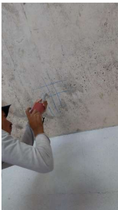
Fotografias n.º 341, 342, 343, 344, 345 e 346 – ensaio de esclerometria da Vivência P31, P32, L1, L2, L3 e L4 (pavimento térreo) respectivamente
