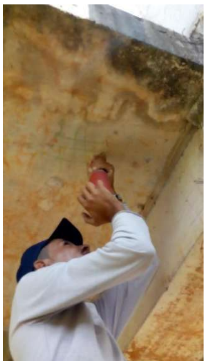
Fotografias n.º 251, 252, 253, 254, 255 e 256 – ensaio de esclerometria do Bloco Pedagógico V1, V2, V5, V6, V7 e V8 (pavimento térreo) respectivamente.
