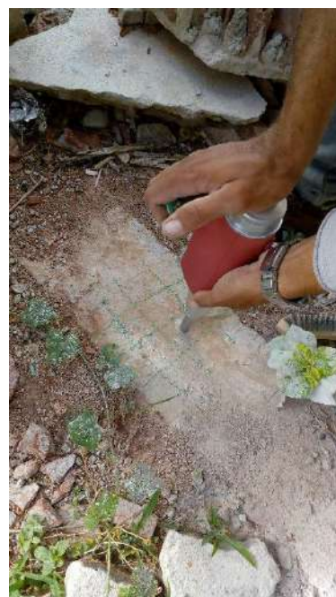
Fotografias n.º 215, 216, 217, 218, 219 a 220 – ensaio de esclerometria do Bloco Pedagógico V9, V10, V11, V12, V13 e V14 (pavimento fundação) respectivamente.
