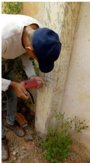
Fotografias n.º 170, 171, 172, 173, 174 e 175 – ensaio de esclerometria da Laboratório P7, P8, P9, P10, P11 e P12 (pavimento térreo) respectivamente.
