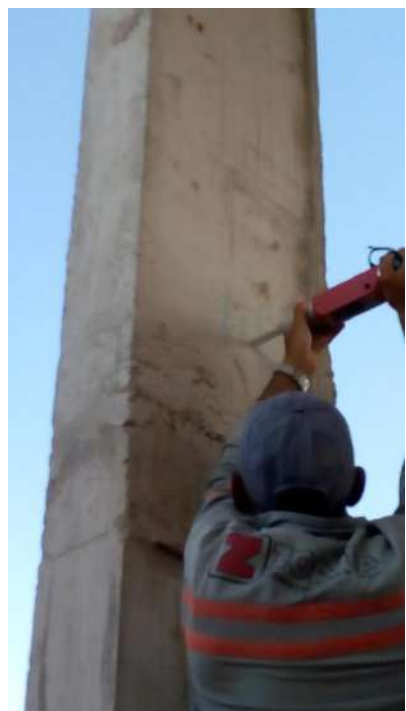
Fotografias n.º 83, 84, 85, 86, 87 e 88 – ensaio de esclerometria da Biblioteca, P7, P8, PC1, PC2, PC3 e L2 (pavimento superior) respectivamente.
