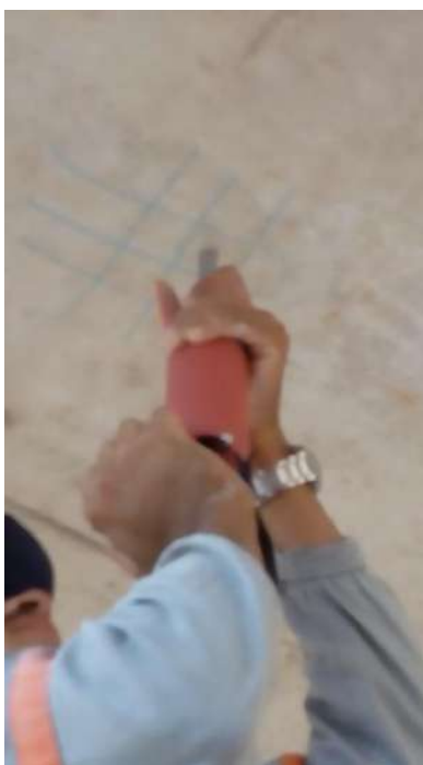
Fotografias n.º 71, 72, 73, 74, 75 e 76 – ensaio de esclerometria da Biblioteca V1, V2, V3, V5, V6 e L1 (pavimento térreo) respectivamente.
