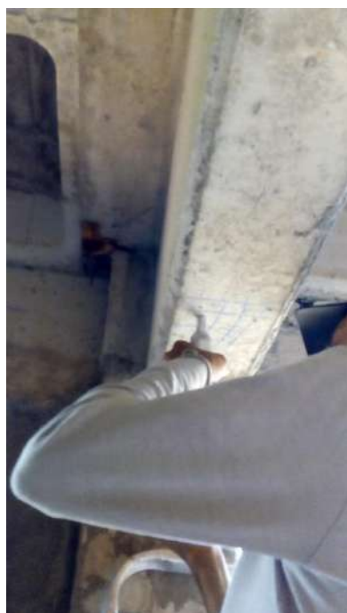
Fotografias n.º 353, 354, 355, 356 e 357 – ensaio de esclerometria da Vivência V5, V6, V7, V8 e V9 (pavimento térreo) respectivamente
