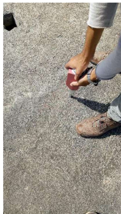
Fotografias n.º 275, 276, 277, 278, 279 e 280 – ensaio de esclerometria do Bloco Pedagógico L9, L10, L11, L12, L13 e L14 (pavimento térreo) respectivamente.
