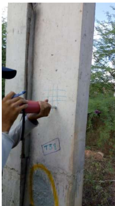
Fotografias n.º 323, 324, 325, 326, 327 e 328 – ensaio de esclerometria da Vivência V14, V15 (pavimento fundação) e P1, P2, P3 e P4 (pavimento térreo) respectivamente.
