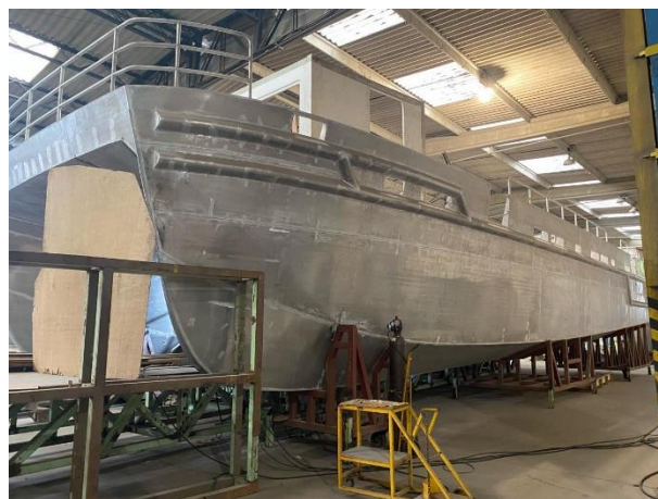
Vista Lateral da EapFlu2 – trabalho de reforço e desempenho de algumas partes do casco
