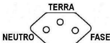
Figura 3. Ligação correta Neutro/Terra/Fase para tomadas de 127V.
