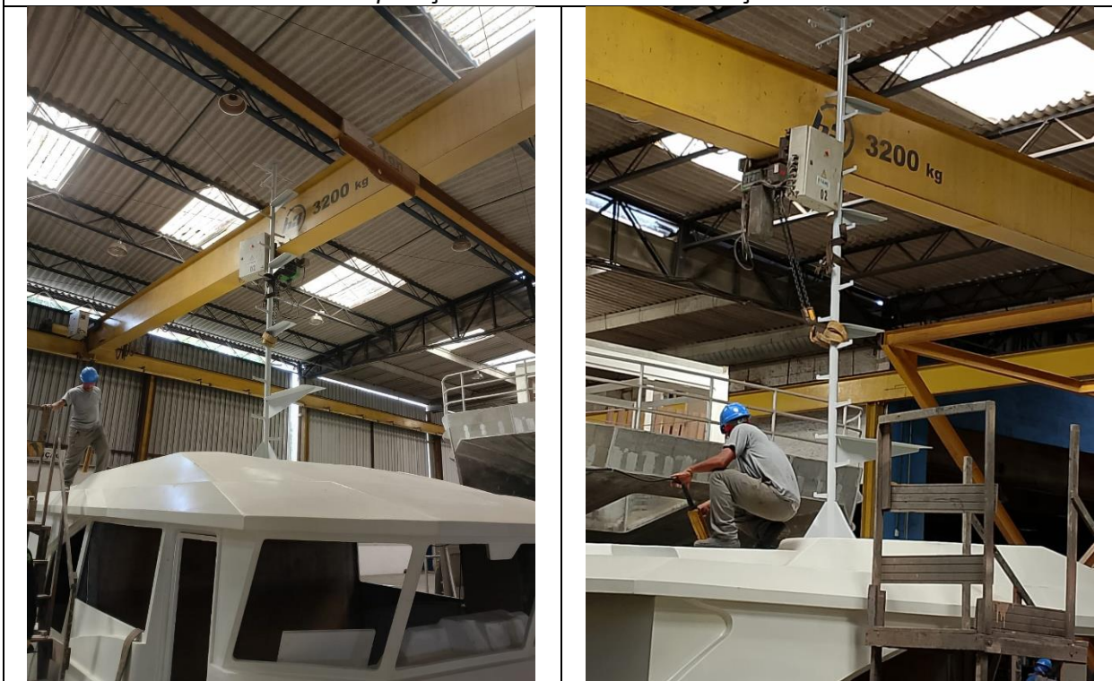
Montagem do mastro da embarcação
