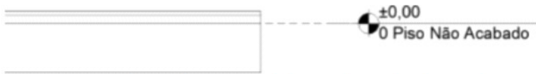
Figura 7- Representação da superfície superior da laje sendo considerada o nível 0 no eixo Z.
